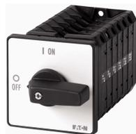
Stufenschalter, T5B, 63 A, Einbau, 6 Baueinheit(en), Kontakte: 12, 30 °, rastend, ohne 0-Stellung, 1-12, Abwicklungs Nr. 15253
