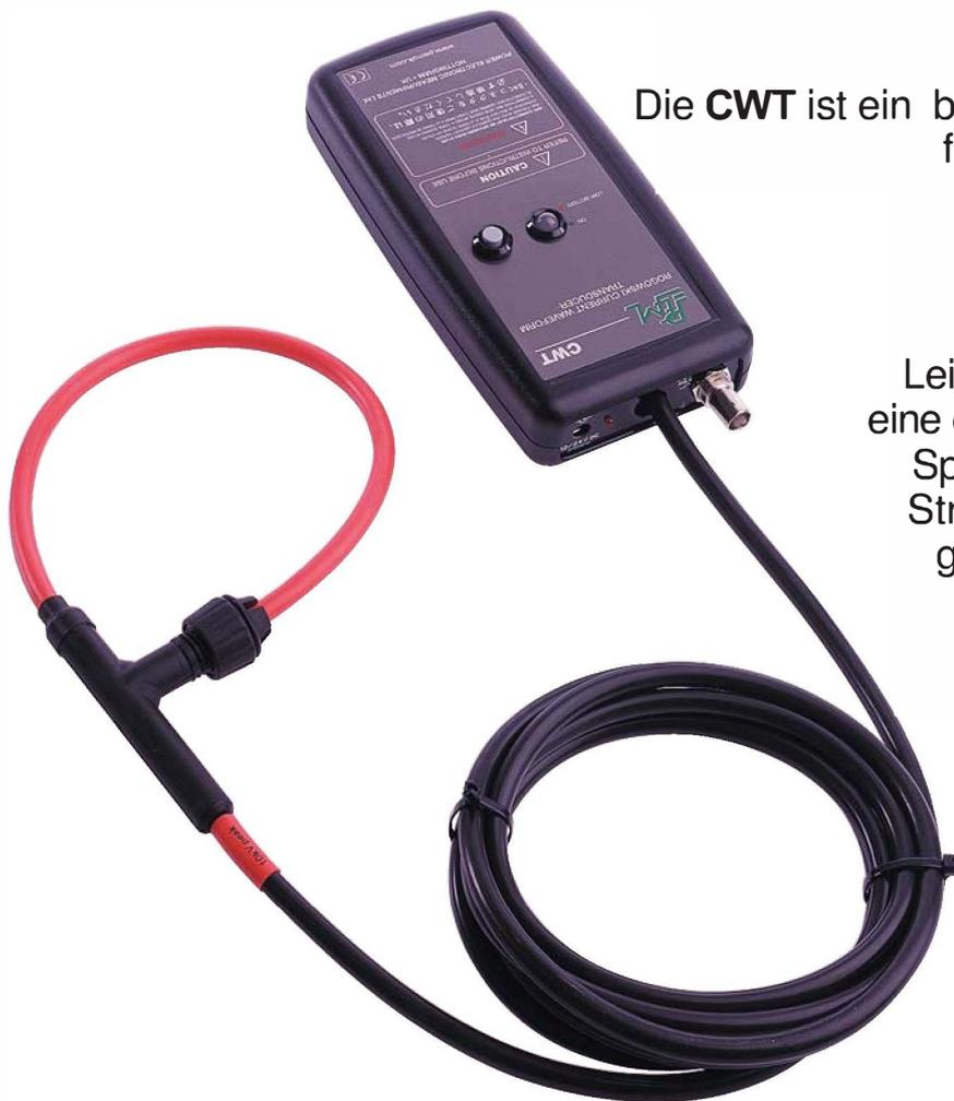
Die **CWT** ist ein breitbandiger, moderner Sensor für Impuls- und Wechselströme
