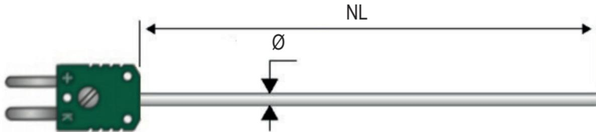
1. Mantelthermoelement NiCr-Ni, Typ K, mit Miniaturstecker am Messgerät in die dafür vorgesehene Buchse einstecken.
