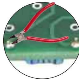
Nach dem Löten die überstehenden Drähte auf der Rückseite mit dem Seitenschneider auf ca. 2 mm kürzen.
