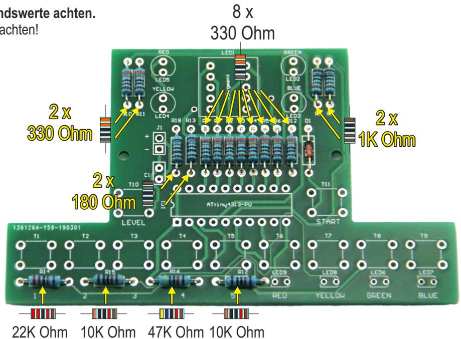
**D Prozessor auflöten.** Beim Prozessor musst Du auf die Polung achten. Dieser hat eine Einkerbung (Rundung) und daran erkennst Du die Ausrichtung. Siehe Zeichnung in rot! Die Rundung muss in diesem Fall nach links ausgerichtet sein!
