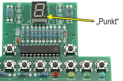
**I Die 4 großen LED's (5 mm) auflöten.** Auf Polung achten - Polung wie auf der Platine angezeichnet! Das längere Beinchen an der LED ist immer PLUS! Überstehende Dráhte kürzen. Achte darauf, dass vor dem Lötén das Bauteil sauber auf der Platine aufliegt!
