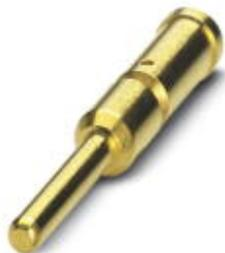
Crimpkontakt, gedreht, Kontaktdurchmesser: 2 mm, Crimpbereich: 0,25 mm<sup>2</sup> ... 1 mm<sup>2</sup>
