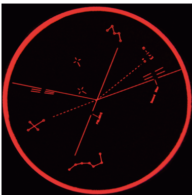
Abb. 6: Polsucher-Gravurplatte mit Großem Wagen (unten) bei gedrehter RA-Achse Beachten Sie den Unterschied zur vorherigen Abbildung des Gravurplättchens:
