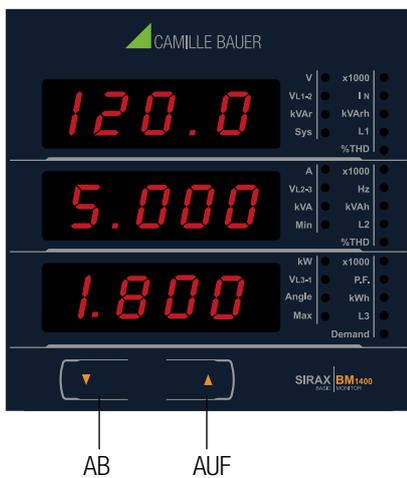
Die folgenden Werte des SIRAX BM1400 können vor Ort konfiguriert und programmiert werden: Spannungswandler-Primärwert, Stromwandler-Primärwert, Stromwandler-Sekundärwert (5 A oder 1 A) und Dreiphasennetz drei- oder Vierleiter System. Auf der Vorderseite befinden sich zwei Tasten, mit denen der Benutzer durch die verfügbaren Messwerte (Momentanwerte, Energie und min./max.-Größen) navigieren und das Gerät konfigurieren kann.
