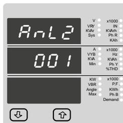
Drücken der "AUF" Taste akzeptiert den gegenwärtigen Wert und führt zur Auswahlanzeige Analogausgang (siehe Abschnitt 7.2.4.1).
