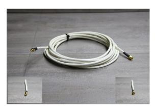
Verbindungskabel SMA Buchse auf SMA Stecker Innenader sowie Aussengeflecht aus Kupfer / Isolierung Aluminiumfolie + Schaumstoff FOAM Aussenmantel PCV (Aussenbereich geeignet) Impedanz 50 Ohm +/- 2 Durchmesser Aussen 5,4mm Temperaturbereich -40C bis +80C Gewicht ca. 48,4kg/km Kapazität 82pF/m bei 1kHz
