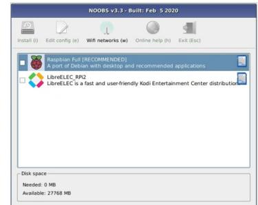
Wenn Sie eine Netzwerkverbindung herstellen, werden an dieser Stelle weitere downloadbare Betriebssysteme (abhängig vom verwendeten Raspberry Modell) angezeigt.
