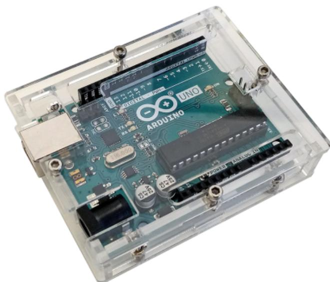
Verwenden Sie die kurzen Schrauben, um das Arduino® Board zu befestigen. Verwenden Sie die Abstandshalter, um die Platine anzuheben.
