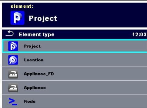
Die Art des Strukturobjekts das hinzugefügt werden soll, kann aus einem Drop-Down-Menü ausgewählt werden.
