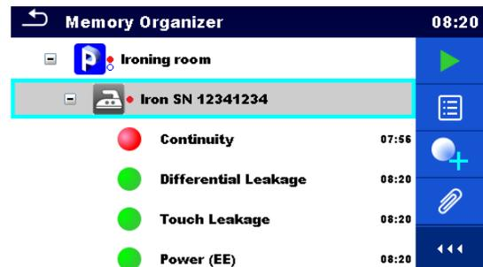
Abbildung 5.6: Bewertung – Messungen nicht abgeschlossen mit fehlerhafte(n) Ergebnisse(n)
