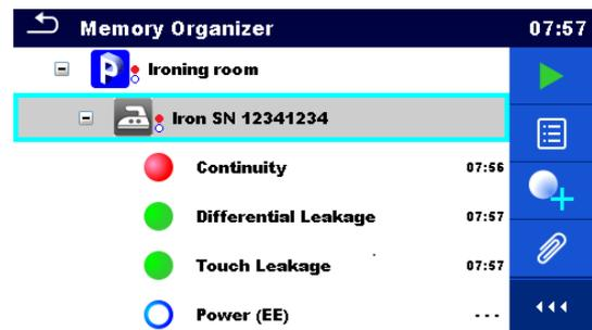
Abbildung 5.5: Beispiel für die Bewertung – Messungen nicht abgeschlossen mit fehlerhaften Ergebnissen
