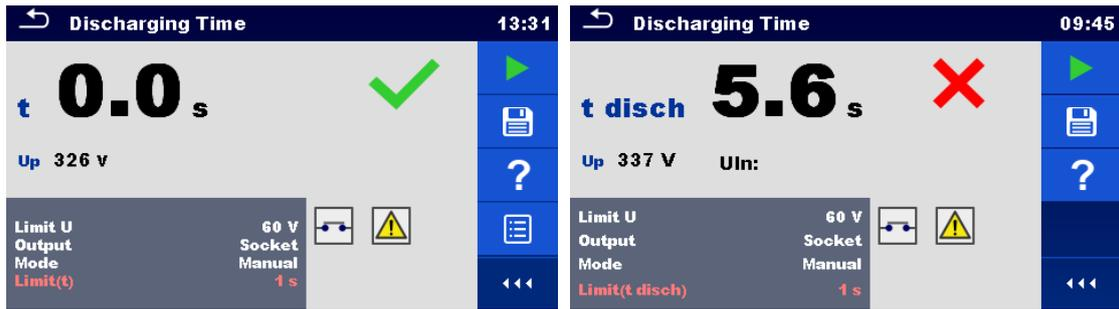
Abbildung 6.65: Beispiele für Ergebnis Entladezeitmessung (Anschluss = Prüfsteckdose)
