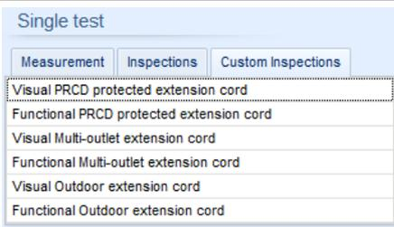
Nach Bestätigung der Auswahl wird die neue Inspektionsdatendatei geöffnet und die Liste der verfügbaren kundenspezifischen Inspektionen ist geändert.
