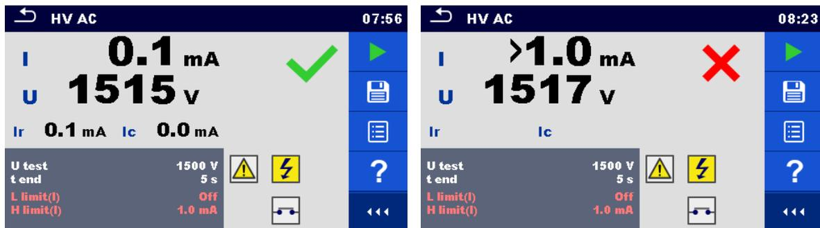
Abbildung 6.24: Beispiele für Ergebnisse der HV AC Prüfung
