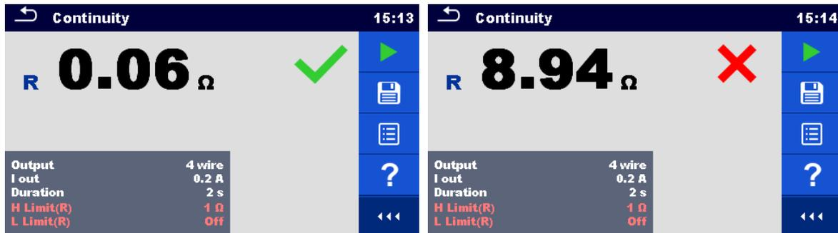
Abbildung 6.19: Beispiele für Ergebnisse der Durchgangsprüfung
