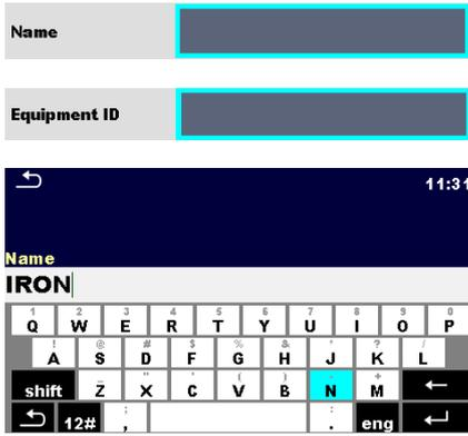
Die Suche kann verkürzt werden, indem ein Text in die Felder der Name und die Geräte-ID eingegeben wird.
