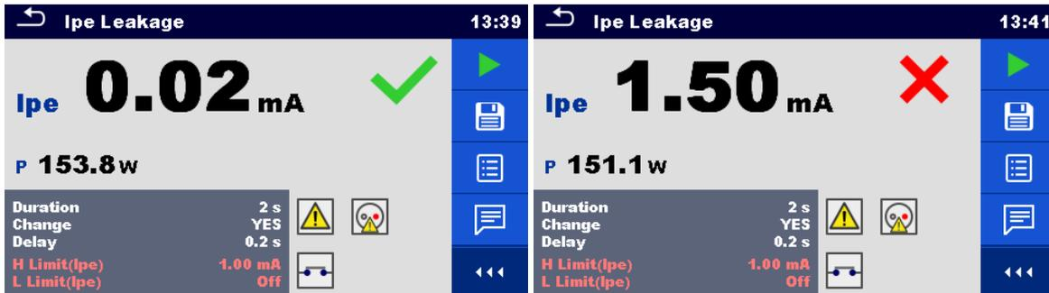
Abbildung 6.50: Beispiele für Ergebnisse Ipe Schutzleiterableitstrom Messung
