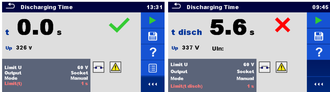
Abbildung 4.53: Beispiele für Ergebnis Entladezeitmessung (Anschluss = Prüfsteckdose)
