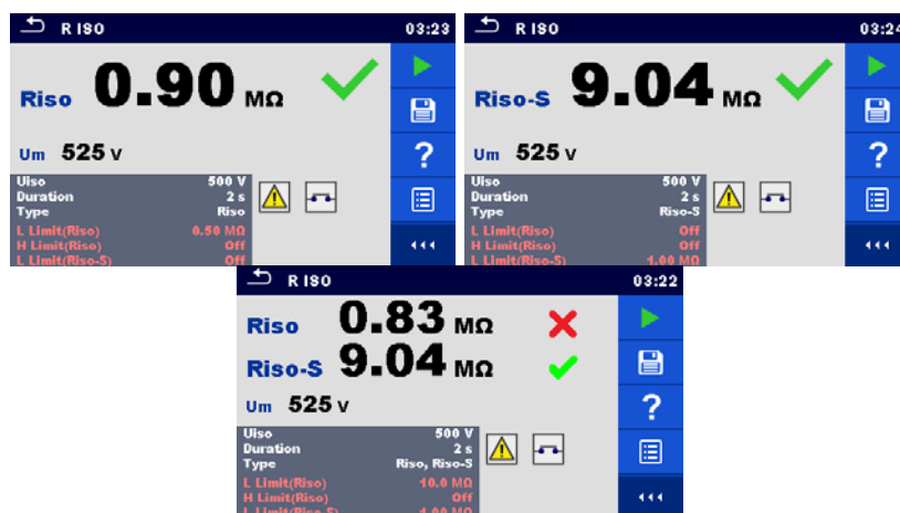
Abbildung 4.27: Beispiele für Ergebnisse der Isolationswiderstandsmessung
