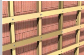
Anbringung von Holzunterkonstruktionen in Hochlochziegel mit dem fisher SXRL
