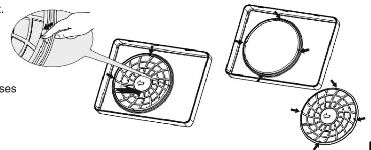
Der Gehäuse ist mit drei runden abgesenkten Platten für Kabeleinführung ausgestattet. Klopfen Sie an der Rückseite eine Platte mit einem Messer heraus um eine Öffnung an der passenden Stelle zu machen.
