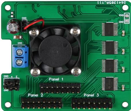
Mit Hilfe dieser Erweiterungsplatine für Ihren Raspberry Pi kann man bis zu 3 RGB-LED-Matrix Reihen mit dem gängigen HUB75 Stecker, z.B. unsere Joy-It RGB-LED-Matrix (LED-Matrix01), ansteuern. Des weiteren ist ein 25x25mm Lüfter verbaut um für ausreichend Kühlung des Raspberry Pis zu sorgen.
