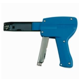
Legrand Spannzange Colring, für Kabelbinder Colring bis max. 4,6 mm Breite, zum Spannen der Kabelbinder und gratfreies Abschneiden der Überlängen in einem Arbeitsgang, Spannstärke nach Skala einstellbar.
