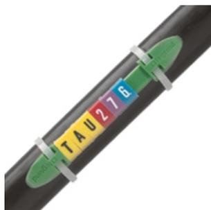
Legrand Etikettenträger Duplix (Gelb), für 14 Kennzeichen, Befestigung mittels Kabelbinder Colring Breite 2,4 oder 3,5 mm, Etikettenträger zur Aufnahme von Duplix Ziffern, Buchstaben und Symbolen, geeignet zur Kennzeichnen von Kabel und Leitungen.
