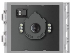
Night & Day-Farbkameramodul mit Weitwinkelobjektiv (135° Horizontal/96° Vertikal) zum Anschluss an das Audio-Türlautsprechermodul Plus Art. 351100 über das mitgelieferte Verbindungskabel. Die automatische N&D-Funktion aktiviert bei entsprechenden Lichtverhältnissen den mechanischen IR-Filter. Ausgestattet mit einem 1/3"-Sensor, IR-LED zur Beleuchtung des Aufnahmebereichs und Antibeschlag-Heizung (Heizwiderstand).
