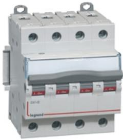
Legrand Lasttrennschalter DX3, 4-polig, 100A 400 VAC, nach EN 60947-3, EN 60669-2-4. Gebrauchskategorie AC-22A. Befestigung auf Hutprofilschiene EN 60715 durch rastende Schnellbefestigungen, klare Information vorne auf jedem Gerät, eindeutige Schaltstellungsanzeige rot/grün am Schalthebel (verriegelbar), mit Beschriftungsfenster, einpolig verschiebbar mit Legrand Stiftkammschienen, Anbau von Hilfsgeräten möglich.
