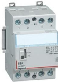
Legrand Installationsschütz CX3, Spulenspannung AC 230 V, 4-polig, Ausführung: 4 Öffner, Bemessungsbetriebsstrom le 63 A/ 400 V AC, mit Handschalter. Nach EN 61095, Gebrauchskategorie AC-1/AC-7a und AC-3/AC-7b, Installationsschütze zum Schalten von Lasten wie z.B. Lampengruppen, Motoren und Heizungen, mit Beschriftungsfenster, mit Schaltzustandsanzeige, Befestigung auf Hutprofilschiene EN 60715 durch rastende Schnellbefestigung, Anbau von Hilfsschaltern möglich.
