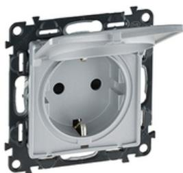
Valena Life Schutzkontakt-Steckdose 16A, Klappdeckel und Abdeckung, mit erhöhtem Berührungsschutz (Kindersicherung), und schraublosen Anschlussklemmen, komplett gekapselter und isolierter Einsatz und Doppelzahn-Spreizkrallen für mehr Halt in der Unterputzdose, Farbe: Aluminium
