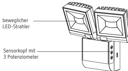
Der LED-Strahler besitzt 3 Potenziometer, um Zeit, Helligkeit und Funktionsmodus einzustellen.
