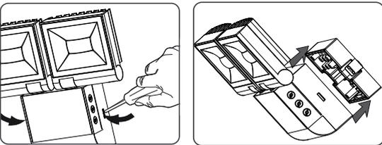
► Markierungen für die Löcher anbringen und Löcher bohren.
