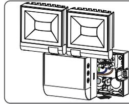
► LED-Strahler mit Netz verbinden
