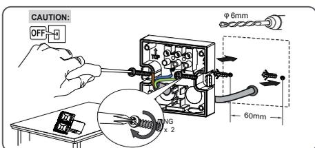
► Einzeladern an der entsprechenden Klemme anschließen und Schrauben festdrehen
