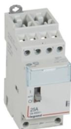
Legrand Installationsschutz CX3, Spulenspannung AC 24 V, 4-polig, Ausführung: 4 Schließer, Bemessungsbetriebsstrom Ie 25 A/ 400 V AC, mit Handschalter. Nach EN 61095, Gebrauchskategorie AC-1/AC-7a und AC-3/AC-7b, Installationsschütze zum Schalten von Lasten wie z.B. Lampengruppen, Motoren und Heizungen, mit Beschriftungsfenster, mit Schaltzustandsanzeige, Befestigung auf Hutprofilschiene EN 60715 durch rastende Schnellbefestigung, Anbau von Hilfsschaltern möglich.
