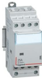
Legrand Installationsschütz CX3, Spulenspannung AC 230 V, 4-polig, Ausführung: 2 Schließer + 2 Öffner, Bemessungsbetriebsstrom je 25 A/ 400 V AC, ohne Handschalter. Nach EN 61095, Gebrauchskategorie AC-1/AC-7a und AC-3/AC-7b, Installationsschütze zum Schalten von Lasten wie z.B. Lampengruppen, Motoren und Heizungen, mit Beschriftungsfenster, mit Schaltzustandsanzeige, Befestigung auf Hutprofilschiene EN 60715 durch rastende Schnellbefestigung, Anbau von Hilfsschaltern möglich.
