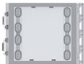
Ruftasten-Modul mit 8 Ruftasten (2-reihig) zur Verwendung mit den Audio-Türlautsprecher-Modulen Art. 351000–351100 bzw. mit den Video-Lautsprechermodulen Art. 351200–351300. Anschluss weiterer Ruftasten- oder Infomodule über das mitgelieferte Verbindungskabel. Anmerkung: Bei Verwendung dieses Ruftastenmodules muss bei den Lautsprechermodulen Art. 351100-351200-351300 der Jumper (J1) gezogen werden.
