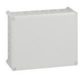
Legrand Abzweigdose Plexo, Rechteckig 310 x 240 x 124 mm (H x B x T), Schutzart IP 55 – IK 07, mit Vorprägung für metrische Leitungseinführung, Deckel mit 1/4-Drehung Schnellverschluss, Lichtgrau RAL 7035, selbstverlöschend 750°C, Beschriftbarer Deckel.
