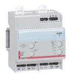
Legrand Verteilereinbaudimmer 1-10 V, Leistung 1000 VA, 4-modulig, Fernsteuerbar durch Taster, Direktsteuerung am Dimmer durch Tastbedienung, mit Anschluss für separate Busleitung, Versorgungsspannung: 230 V 50/60 Hz, für Ein-, Aus- und Helligkeitssteuerung, Befestigung auf Hutprofilschiene EN 60715 durch rastende Schnellbefestigung.
