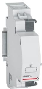
Legrand Arbeitsstromauslöser, Steuerspannung 12-48 V AC/DC, zum Fernausschalten von LS-Schalter, FI-/ FILS-Schutzschalter der Legrand TX3 und DX3 Serie. Werkzeuglose Montage durch einfaches Einklinken an der linken Seite des Hauptgerätes, Maximal ein Befehlsgerät am Hauptgerät.
