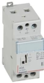
Legrand Installationsschütz CX3, Spulenspannung AC 24 V, 2-polig, Ausführung: 2 Schließer, Bemessungsbetriebsstrom je 40 A/ 250 V AC, mit Handschalter. Nach EN 61095, Gebrauchskategorie AC-1/AC-7a und AC-3/AC-7b, Installationsschütze zum Schalten von Lasten wie z.B. Lampengruppen, Motoren und Heizungen, mit Beschriftungsfenster, mit Schaltzustandsanzeige, Befestigung auf Hutprofilschiene EN 60715 durch rastende Schnellbefestigung, Anbau von Hilfsschaltern möglich.
