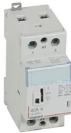
Legrand Installationsschütz CX3, Spulenspannung AC 230 V, 2-polig, Ausführung: 2 Schließer, Bemessungsbetriebsstrom le 40 A/ 250 V AC, brummfrei, mit Handschalter. Nach EN 61095, Gebrauchskategorie AC-1/AC-7a und AC-3/AC-7b, Installationsschütze zum Schalten von Lasten wie z.B. Lampengruppen, Motoren und Heizungen, mit Beschriftungsfenster, mit Schaltzustandsanzeige, Befestigung auf Hutprofilschiene EN 60715 durch rastende Schnellbefestigung, Anbau von Hilfsschaltern möglich.
