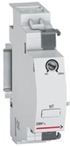
Legrand Unterspannungsauslöser, Betriebsnennspannung 24-48 V AC/DC, zum Auslösen bei Unterspannung bzw. Spannungsunterbrechung. Kurzzeitige Spannungsunterbrechung unterdrückbar (Einstellbereich 300 ms). Anbaubar an LS-Schalter, FI-/ FILS-Schutzschalter der Legrand TX3 und DX3 Serie. Werkzeuglose Montage durch einfaches Einklinken an der linken Seite des Hauptgerätes, Maximal ein Befehlsgerät am Hauptgerät.
