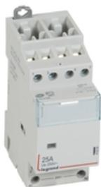
Legrand Installationsschutz CX3, Spulenspannung AC 24 V, 4-polig, Ausführung: 2 Schließer + 2 Öffner, Bemessungsbetriebsstrom Ie 25 A/ 400 V AC, ohne Handschalter. Nach EN 61095, Gebrauchskategorie AC-1/AC-7a und AC-3/AC-7b, Installationsschütze zum Schalten von Lasten wie z.B. Lampengruppen, Motoren und Heizungen, mit Beschriftungsfenster, mit Schaltzustandsanzeige, Befestigung auf Hutprofilschiene EN 60715 durch rastende Schnellbefestigung, Anbau von Hilfsschaltern möglich.
