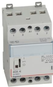
Legrand Installationsschütz CX3, Spulenspannung AC 230 V, 4-polig, Ausführung: 4 Schließer, Bemessungsbetriebsstrom le 40 A/ 400 V AC, brummfrei, mit Handschalter. Nach EN 61095, Gebrauchskategorie AC-1/AC-7a und AC-3/AC-7b, Installationsschütze zum Schalten von Lasten wie z.B. Lampengruppen, Motoren und Heizungen, mit Beschriftungsfenster, mit Schaltzustandsanzeige, Befestigung auf Hutprofilschiene EN 60715 durch rastende Schnellbefestigung, Anbau von Hilfsschaltern möglich.
