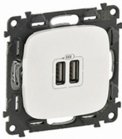
Valena Allure USB-Ladesteckdosen, 2-fachZ. B. zum Laden von Smartphones, MP3-/MP4-Player und Tablets. Ausgangsspannung 5 V mit maximalem Ladestrom von 2400 mA bei einem Gerät oder 1200mA pro Ausgang bei gleichzeitigem Laden von 2 Geräten/ Konform nach IEC 62684-2011-01 Schraubklemmenanschluss: 230 V~ Geliefert inkl. Abdeckung, Ladekabel nicht im Lieferumfang enthalten. Farbe: Perlmutt
