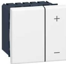
Legrand LED-Tastdimmer Mosaic, Leistung: 3 - 400 W für Glüh-und Hochvolt-Halogenlampen, 3 - 75 W für dimmbare LEDs und Kompakt-Leuchtstofflampen, Lastart: R,L,C, einfache Bedienung direkt am Gerät durch 2-Tasten-Betätigung, Fernsteuerbar durch Steuereingang für unbeleuchtete Taster (Steuerleitung max. 50 m). Tastdimmer 2,5-modulig, weiß. Zur Montage auf Hutprofilschiene EN 60715 mit Hutschienenadapter DX3 Best.-Nr. 412950.
