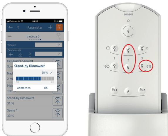
① LED-Leuchte strahlt bei Dunkelheit auf eingestellte 30 %. Bei Bewegung schaltet er auf 100 %.
