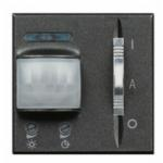
Passiv-Infrarot-Bewegungsmelder mit justierbarer Helligkeit und Abfallverzögerung von 30 Sekunden bis 10 Minuten, frontseitiger Schiebeschalter "Ein/Aus/Automatik" - Schließerkontakt 6A (ohmsch) Stromversorgung 230V a.c. (3-Leiteranschluss), Eingang für ext. Steuerkontakt – 2-modulig, Farbe: **Anthrazit**
