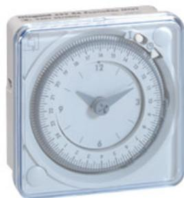
Legrand EconoRex MT, analoge Tageszeitschaltuhr mit Synchronmotor (netzsynchrone Ganggenauigkeit) für Fronttafeleinbau und Wandmontage, 1 Kanal, Betriebsspannung 230 V 50 Hz. Flachsteckeranschluss, Zeiger vorwärts und rückwärts drehbar, dadurch leichte Umstellung (z.B. Sommer-/Winterzeit), Tagesscheibe mit unverlierbaren Segmenten, kürzeste Schaltzeit 20 Min., Wandmontage mittels Wandhalterung Best.-Nr. 049594 optional, Abmessung (HxB): 72 x 72 mm, Schaltausgang: 1 Wechsler.
