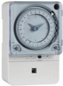
Legrand PolaRex QKT, analoge Abtauschaltuhr mit Quarzmotor (Ganggenauigkeit +/- 1 Sek/Tag, Gangreserve 100 Std.), 1 Kanal, Betriebsspannung 230 V 50/60 Hz. Schaltuhr mit Tagesscheibe und einstellbaren Kurzzeitprogrammen, Schaltzeit von 1 bis 60 Min. einstellbar. Die kürzeste Schaltfolge (Beginn einer Schaltzeit): 30 Min.. Montage auf Tragschiene EN 60715 oder Aufputz, Abmessung (HxB): 113,7 x 72 mm. Schaltausgang: 1 Wechsler.
