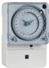
Legrand PolaRex KT, analoge Abtauschaltuhr mit Synchronmotor (netzsynchrone Ganggenauigkeit), 1 Kanal, Betriebsspannung 230 V 50 Hz. Schaltuhr mit Tagesscheibe und einstellbaren Kurzzeitprogrammen, Schaltzeit von 1 bis 60 Min. einstellbar. Die kürzeste Schaltfolge (Beginn einer Schaltzeit): 30 Min.. Montage auf Tragschiene EN 60715 oder Aufputz, Abmessung (HxB): 113,7 x 72 mm. Schaltausgang: 1 Wechsler.
