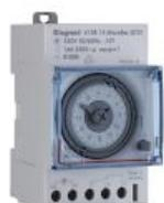
Legrand MicroRex QT31, analoge Tageszeitschaltuhr mit Quarzmotor (Ganggenauigkeit +/- 2,5 Sek/Tag, Gangreserve 100 Std.), für Verteilereinbau, 1 Kanal, Betriebsspannung 230 V 50/60 Hz, mit Handschalter: EIN-Automatik-AUS, mit unverlierbaren Schaltsegmenten, Zeiger vorwärts und rückwärts drehbar, dadurch sehr leichte Einstellung von z.B. Sommer- und Winterzeit, Deckel plombierbar, kürzeste Schaltzeit: 30 Min.. Schaltausgang: 1 Wechsler.
