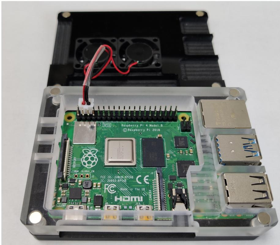
Zum Schluss müssen Sie noch das Gehäuse schließen, indem Sie den Deckel oben auflegen, so dass die Magneten die Gehäuseteile zusammen halten.
