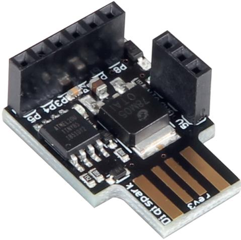
Der Digispark Mini ist ein nur 26mm x 12mm kleiner Microcontroller. Er kann direkt über die Arduino IDE programmiert werden. Darüber hinaus ist er nun mit 6 I/O Buchsen, 8K Flash, sowie I2C und SPI ausgestattet.
