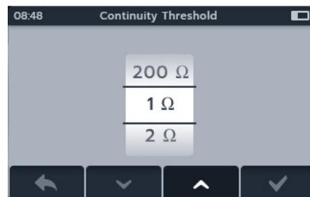
7. Drücken Sie die Softkeys 2 und 3, um das Karussell nach links oder rechts durch die Untermodi auf Unidirektional zu bewegen.
