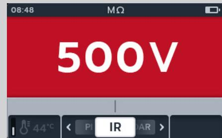
5. Drücken Sie die Softkeys 2 und 3, um das Karussell nach links oder rechts durch die Untermodi auf DAR (Dielektrisches Absorptionsverhältnis) zu bewegen.
