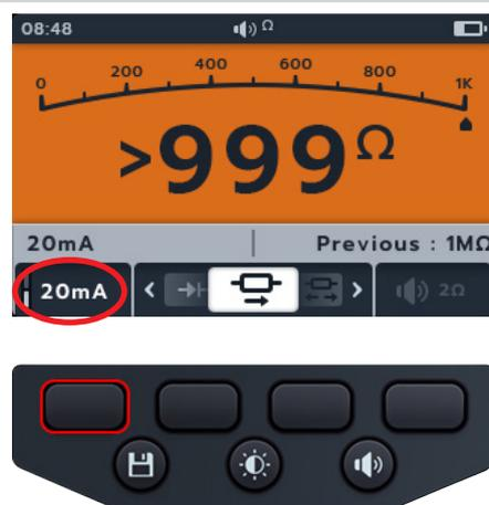
9. Nullen Sie die Messleitungen durch Berühren der beiden Prüfspitzen. Drücken Sie die TEST-Taste, bis auf dem Bildschirm NULL (Symbol) angezeigt wird. Der Ohm-Wert auf dem Primärbildschirm zeigt 0 Ohm an.
