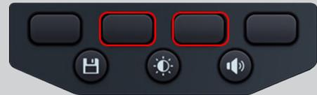
5. Drücken Sie den Softkey 1, um zwischen 120 Hz und 1.000 Hz umzuschalten
