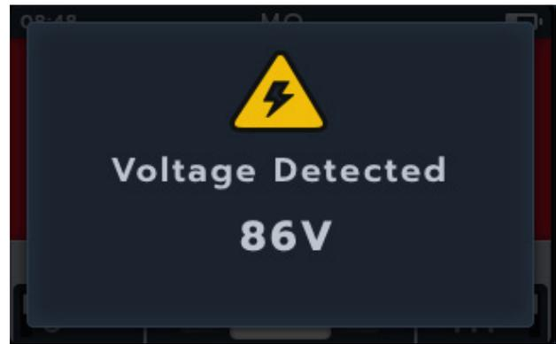
Die Sperrspannung ist in allen Prüfmodi aktiv. Sie ist fest für eine Aktivierung bei 20 V codiert. Die einzige Ausnahme sind die Isolationswiderstandsprüfungen, bei denen die Sperrspannung in den Einstellungen festgelegt werden kann (20 V, 30 V, 50 V oder 75 V).
