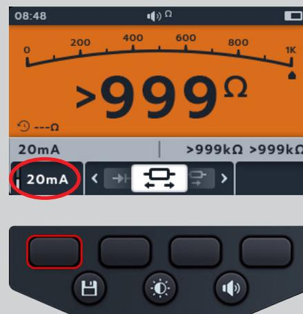
5. Nullen Sie die Messleitungen durch Berühren der beiden Prüfspitzen. Drücken Sie die TEST-Taste, bis auf dem Bildschirm NULL (Symbol) angezeigt wird. Der Ohm-Wert auf dem Primärbildschirm zeigt 0 Ohm an.
