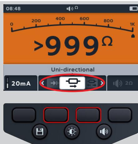
8. Der Prüfstrom kann zwischen 200 mA und 20 mA mit dem Softkey 1 umgeschaltet werden
