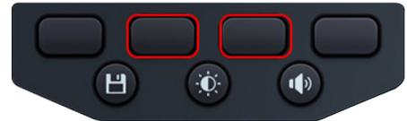
6. Drücken Sie bei Bedarf den Softkey 1, um die Temperaturkompensation ein- oder auszuschalten.
