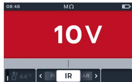
6. Drücken Sie die Softkeys 2 und 3, um das Karussell nach links oder rechts durch die Untermodi zu bewegen. IR ist die Standardeinstellung. Blättern Sie zu 3P, PI, T(s) DAR.
