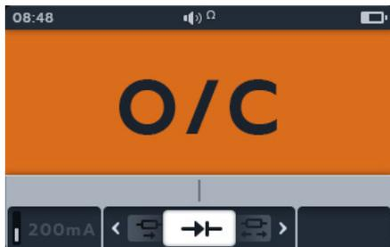
**HINWEIS:** Der Benutzer ist für den Anschluss der Prüfspitzen an die zu prüfende Diode verantwortlich. Im Sekundärfeld werden zu diesem Zeitpunkt keine Informationen angezeigt. Die einzige Information, die angezeigt werden muss, ist die Diodenabfallspannung, wenn das Gerät eine Spannung im Gerät erfasst. Wenn kein Strom fließt, zeigt das Hauptdisplay „O/C“ an.
