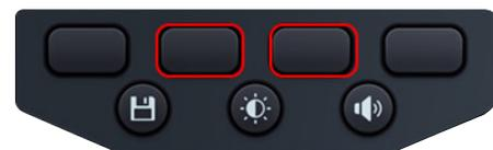
4. Der Prüfstrom kann durch Drücken des Softkey 1 zwischen 200 mA und 20 mA umgeschaltet werden.
