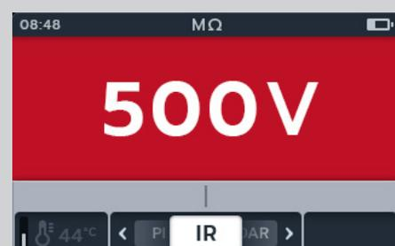
5. Drücken Sie die Softkeys 2 und 3, um das Karussell nach links oder rechts durch die Untermodi zu bewegen. IR ist die Standardeinstellung. Blättern Sie zu 3P, PI, T(s) DAR.
