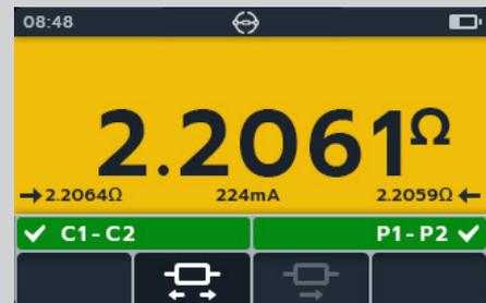
10. Das Ergebnis kann durch Drücken der SAVE-Taste gespeichert werden. Sie werden in einer Meldung darüber informiert, welche Daten gespeichert wurden und unter welcher Asset-ID sie gespeichert wurden.
