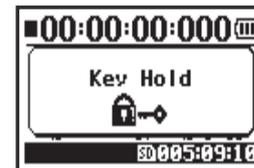
Wenn Sie bei aktiver HOLD-Funktion eine Taste auslösen, blendet das Display für zwei Sekunden „Key Hold“ ein. Um die HOLD-Funktion zu deaktivieren, bewegen Sie den POWER-Schalter weg von der Position HOLD.
