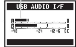
Über die Verbindung zum Computer können je zwei Kanäle bei 44,1 und 48 kHz übertragen und empfangen werden.
