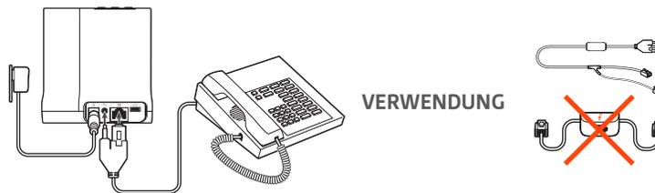
**WICHTIG** Verwenden Sie die Konfiguration „A“ an der Seite der Basisstation, die für die meisten Telefone einschließlich *Cisco-Telefone* geeignet ist.
