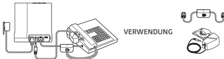
**WICHTIG** Für *Cisco-Telefone* wird die Konfiguration „D“ an der Seite der Basisstation verwendet. Für die meisten anderen Telefone wird die Standardkonfiguration „A“ verwendet.
