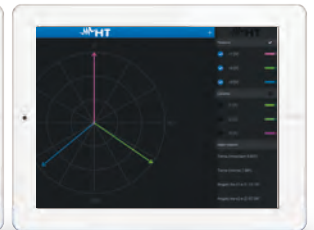
Strom und Spannung im Vektordiagramm.
