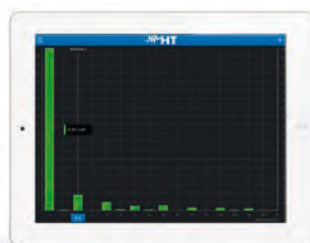
Oberwellen von Strom und Spannung
