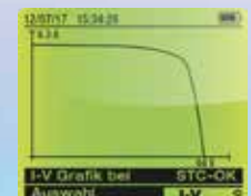
Ergebnisse können sofort grafisch als I-U Kennlinie dargestellt werden, inklusive automatischer Auswertung OK / Nicht OK
