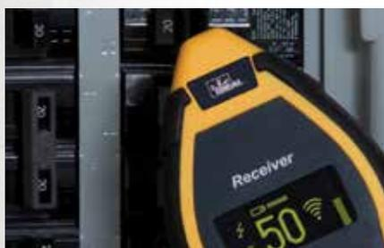
Im Sicherheits-Modus erkennt der Empfänger den Stromkreis, an den der Sender angeschlossen ist.
